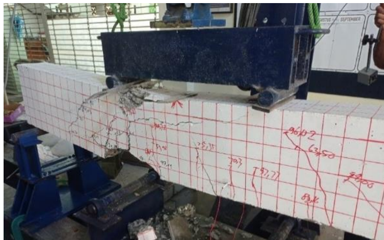
Gambar 9. Keruntuhan Pada Balok BMS (Clamp)
